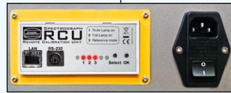
RCU-Rückseite mit LAN- und RS-232-Anschluss
