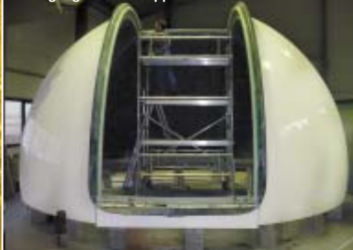
Anfertigung einer 5M Kuppel in unserer Produktionshalle
