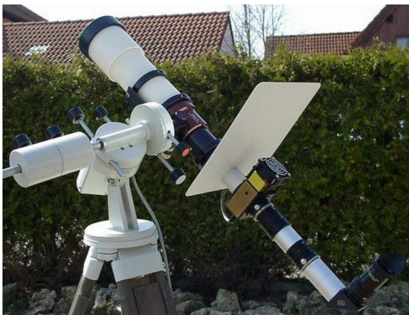
90mm Astro Physics Stoweaway Refraktor mit Solar Spectrum Research Grade 0,2A Filter, 4-fach telezentrischem System (Best.#2959256) Schattenblech (Best.#2459279)
