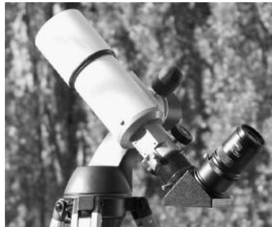
Die beiden Bilder zeigen Umbaubeispiele für die GT 60/80. Links ein Celestron C90 Spotting Scope und rechts ein älterer Vixen Refraktor mit 80/400 mm und angesetztem 2 Zoll Zeiss - Prisma und einem 2" Eudiaskopischen 25mm Okular.
