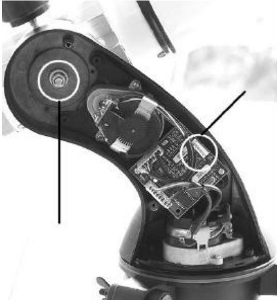
Links sehen Sie im Bild den offenen Gabelarm. Sie können die Steckverbindung des Kabels vorsichtig von der Platine abziehen und dann die Abdeckung beiseite legen (rechter weißer Kreis mit schwarzem Strich).
