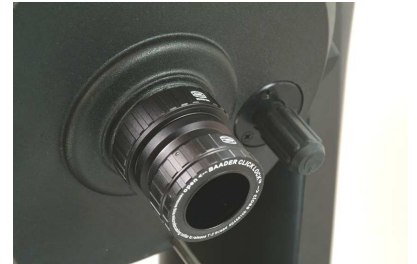
BTA (Baader T-Adapter #21) und ClickLock® (#8) am Celestron C8 Fernrohrtubus
