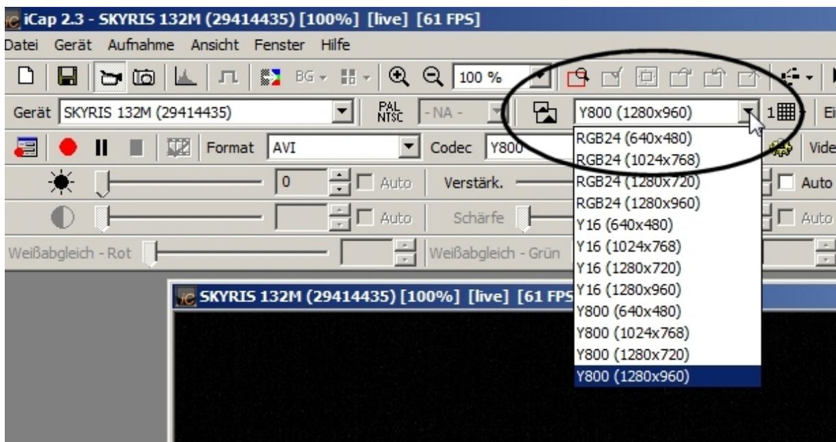
Bei der Wahl des Videocodecs öffnet sich – bei einer angeschlossenen Aptina Kamera – das Untermenü, in der Sie bereits einige fest eingestellte Subframegrößen wählen können. Dies gilt sowohl für die Farbversion (RGB 24) als auch für die beiden monochromen Codecs Y800 (8bit) und Y16 (12bit).
