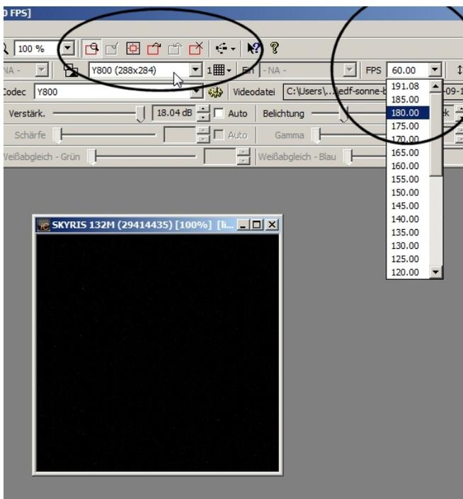
Selbstverständlich sind Sie nicht auf eine fest eingestellte Subframegröße festgelegt. Über die Einstellung der ROI Funktion (06.1), können beliebige Subframegrößen gewählt werden. Auch hier wird die maximal mögliche downloadrate der Bilder unter FPS automatisch angepasst. Bei einer Bildgröße wie im Beispiel links ( 288 x 284 Pixel) wird der download von fast 200 Bilder pro Sekunde möglich.
