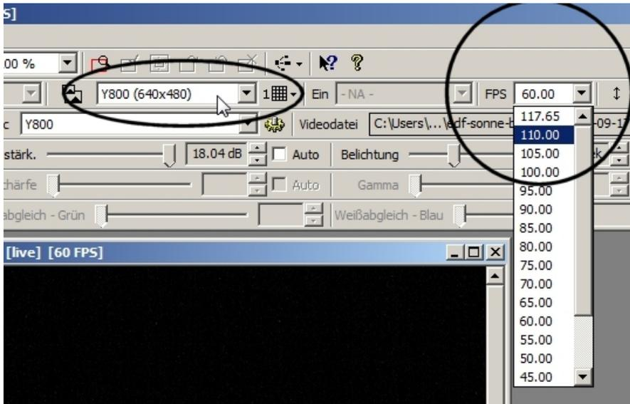
Im Beispiel links wurde der monochrome y800 Codec und eine Bildgröße von 640 x 480 Pixel gewählt (z.B. für die Aufnahme von Planeten Avis).
