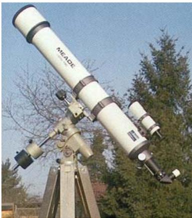
*<<Das erste Testgerät, ein 127-mm-Refraktor ( $f=1180\text{mm}$ ) von Meade auf einer modifizierten Super Polaris Montierung von Vixen.*
