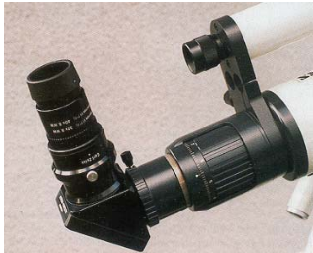
Abb. 06: Mit Hilfe der neuen Fernrohradapter können die Diascope-Okulare auch an astronomischen Fernrohren verwendet werden. a) Links der 1-1/4 Zoll Adapter mit 30-fach vergrößerndem Weitwinkelokular. In der Bildmitte ist der 2 Zoll-Adapter zu erkennen, rechts daneben das Vario. b) Die Montage des 2-Zoll-Adapters mit 40-fach vergrößerndem Weitwinkelokular am 2 Zoll- Zenitspiegel eines Teleskops.
