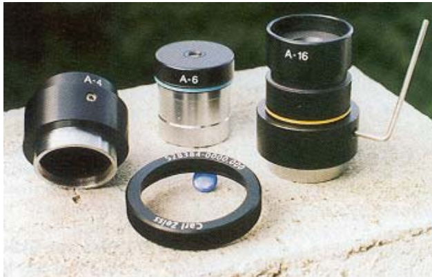
Abb. 04: Der Astro-Adapter ermöglicht den Einsatz von 1-/4-Zoll- Steckokularen. Er besteht aus einem Adapterring, der mit Hilfe einer Inbusschraube an das jeweilige Okular gekoppelt wird. Vorne im Bild befindet sich der Überwurfing, der das Okular vor dem Herausfallen aus der Bajonettöffnung sichert.
